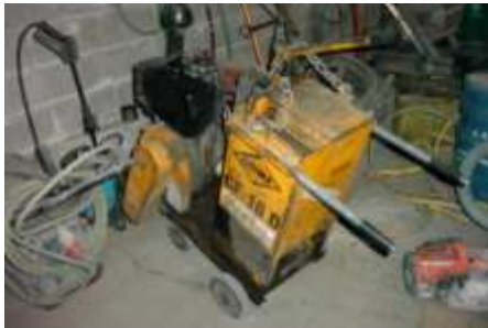
Slibemaskine til betongulve, 380 volt.
